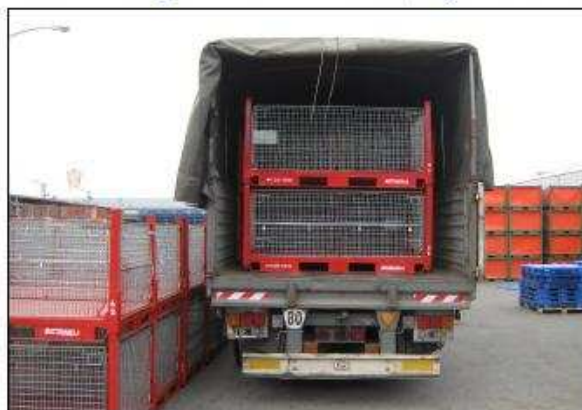
Semirremolque convencional (Capacidad 84,8 m3)
