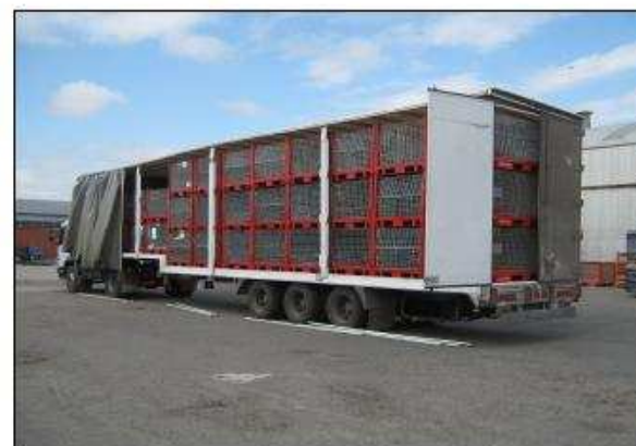
Semirremolque Saider techo desplazable (Capacidad 116 m3)
