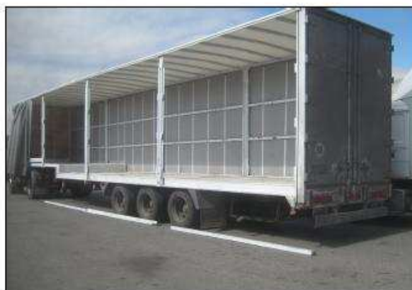
Semirremolque convencional (Capacidad 84,8 m3)
